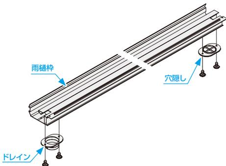
ドレイン・穴隠しを防水ねじで取付けることで、取付け前のシーリングや取付け後のねじ部のシーリングをなくしました。
