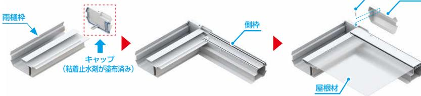
・キャップを雨樋枠に取付け
