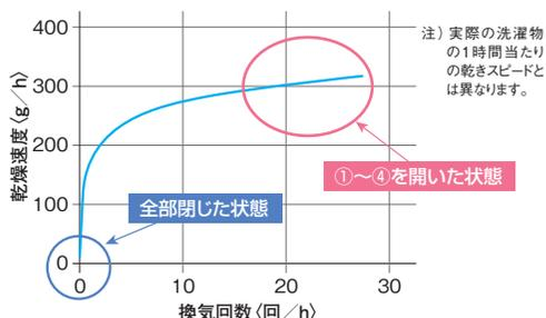
日射がない、または少ない時でも換気框、換気柵を開いた状態で洗濯物を干すと、閉め切った時よりも洗濯物の乾燥速度は速くなります。
