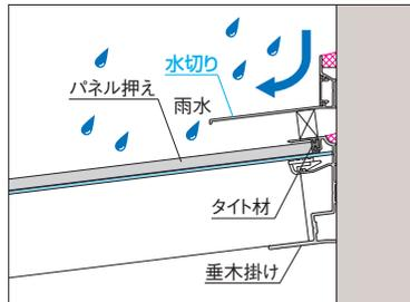
垂木掛けの上に水切りを取り付けることで、雨水をさらにガードします。
