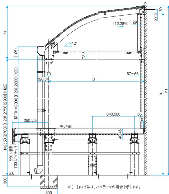
●側面図<1500・3000タイプ 出幅3尺~6尺>
