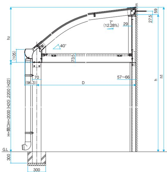
●側面図〈1500・3000タイプ 出幅3尺~6尺〉
