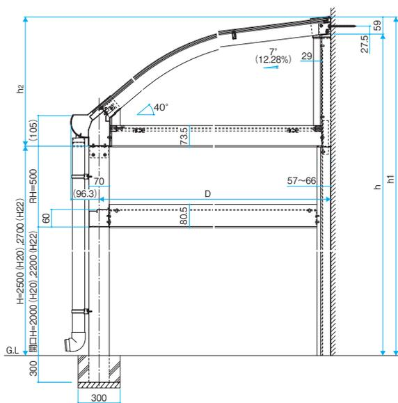
●側面図〈1500・3000タイプ 出幅3尺~6尺〉
