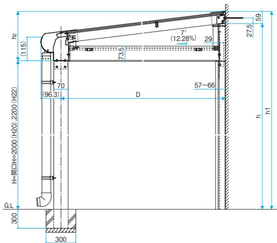
●側面図〈1500・3000タイプ 出幅3尺~6尺〉
