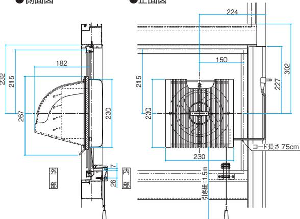
■換気扇 [FIX窓に取り付けの場合]
