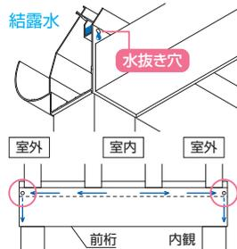
●水抜き穴は前桁両端部(室外・躯体側面)にあります。
