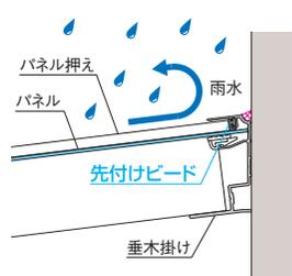
先付けボードによりパネル押えのシーリング処理が不要です。
