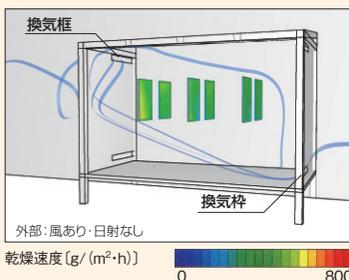
「晴れもようwith」は、外出時、窓を閉め切った状態でも換気框・換気柵から風を採り込むことができ、洗濯物を効率よく乾かすことができます。日中の通風・換気はもちろん、夜間でも施錠しながら換気ができるガラスルーバー窓など、換気アイテムを強化しています。
