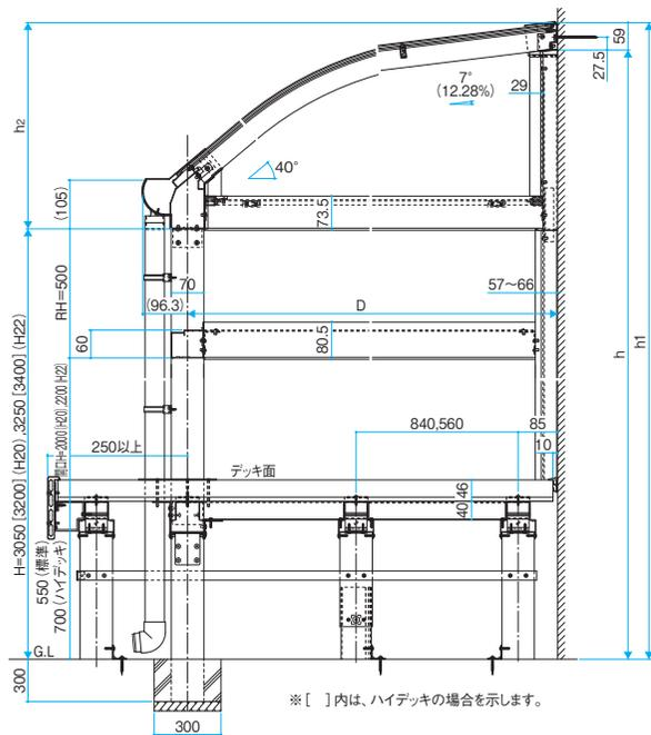
●側面図<1500・3000タイプ 出幅3尺~6尺>
