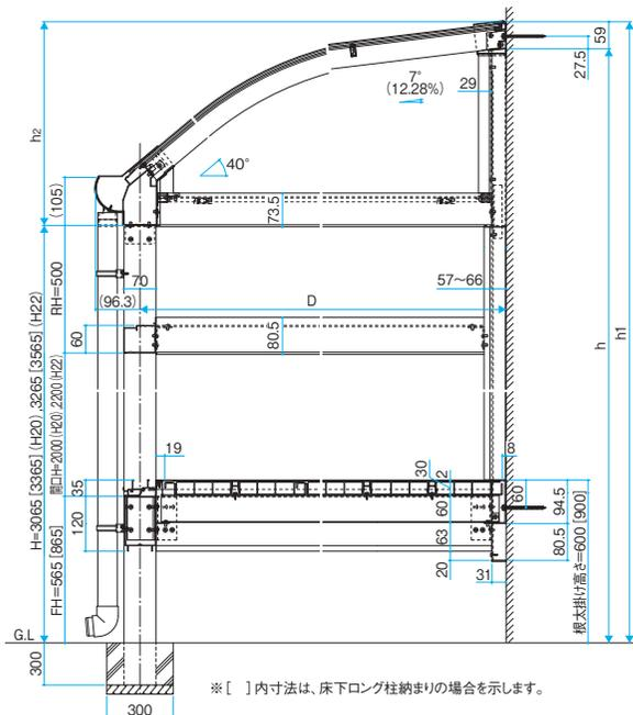
●側面図〈1500・3000タイプ 出幅3尺~6尺〉
