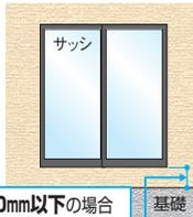
サッシ下枠と基礎のすき間が100mm以下の場合「水切り逃げ納まり」にて対応可能です。
