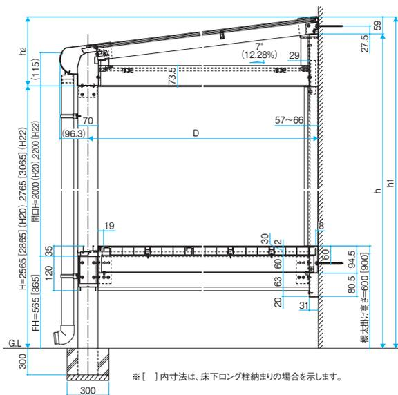
●側面図〈1500・3000タイプ 出幅3尺~6尺〉
