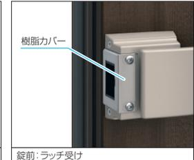
全長戸当り・制振材を使用し、さらに丁番の軸受け部に樹脂を組み合わせ扉開閉時における形材門扉特有の金属やラッチの共鳴音を低減させました。タッチ錠の場合、錠前ラッチ受け部には樹脂カバーを設け、ラッチ納まり時の接触音を低減しました。また、扉内部に吸音材を使用し、開閉時の反響音を抑えます。
