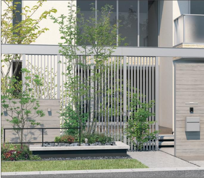
カーポートの梁下に取り付けできる四角格子セットです。四角格子とデザインユニット用柱を組み合わせて設置できます。デザインユニット用柱は柱内々寸法925mm以下、四角格子は70mmピッチで最大12本まで柱間に設置できます。
