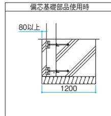
【吊下げタイプ※1】 ※1. 梁置きタイプの場合も図中の寸法は同じです。
