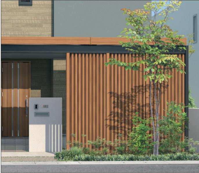
カーポートの梁下に取り付けできる角度格子セットです。角度格子を採用することで半目隠しタイプのスクリーンが実現。角度格子とデザインユニット用柱を組み合わせて設置できます。デザインユニット用柱は柱内々寸法925mm以下、角度格子は90mmピッチで最大10本まで柱間に設置できます。
