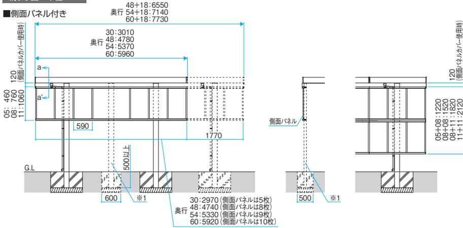
※1. 片側2本柱の場合、側面パネル用柱(160×75)になります。奥行30と側面パネル高さ05の場合、柱は不要です。
