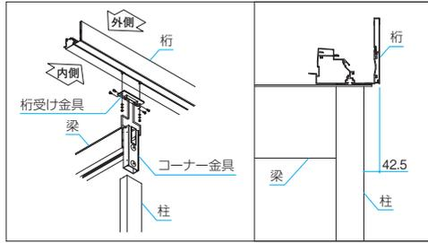
梁置きタイプで桁を柱の真上に取り付ける場合に追加手配してください。
