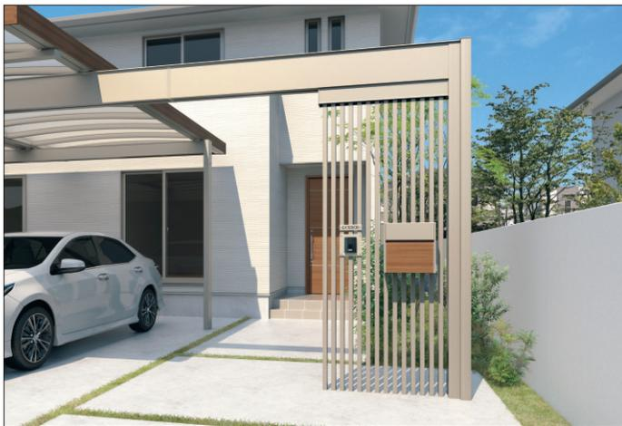
カーポートの梁下に取り付けできるたて格子のスクリーンを用意しています。柱から間口方向に980mmの範囲で設置でき、LED照明内蔵のガラスパネル(消費電力1.5W、全光束上下各35lm)や表札・ポスト・照明・インターホンとの組み合わせも可能で、ファサード感覚の演出ができるのも魅力です。
