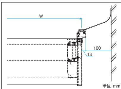
外壁とのすき間をカバーし、雨水の浸入を軽減します。また、本体に取り付けるため、外壁に一切ねじ止めをしない仕様です。
