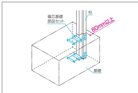
隣地境界にカーポート柱を設置する場合などに基礎の張り出しを80mmまで小さくできます。施工の自由度が向上します。なお、両側支持タイプの場合、偏心基礎部品を使用せずに偏心基礎対応が可能です。
