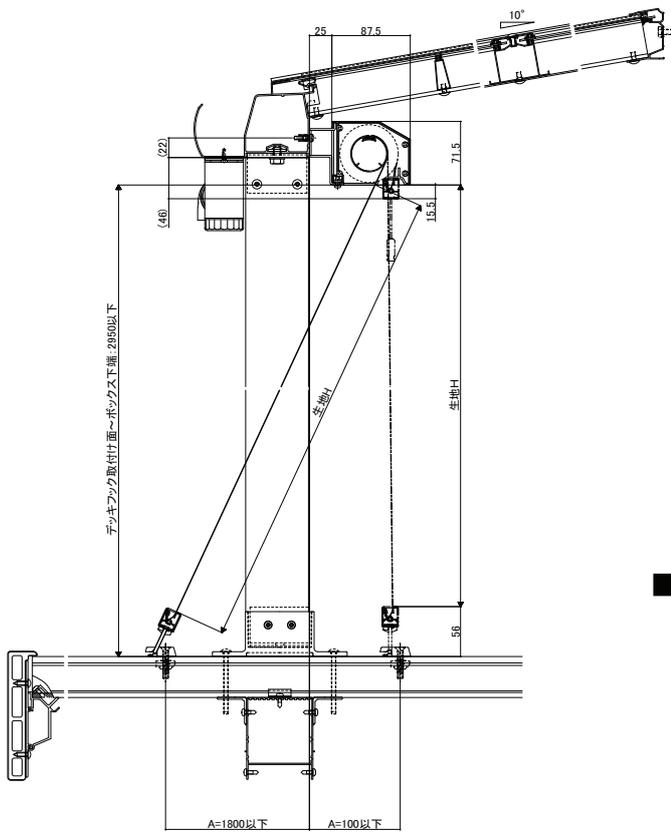
※Aは、デッキフック取付けねじ~ブラケット取付け面を示す。
