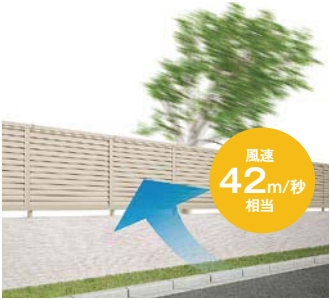
柱ピッチを1,000mm以内で施工することで耐風圧強度：風速42m/秒相当仕様となります。(T-14を除く)
