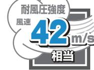
支柱ピッチを1000mm以下で施工すれば、耐風圧強度が風速42m/s相当にアップします。
